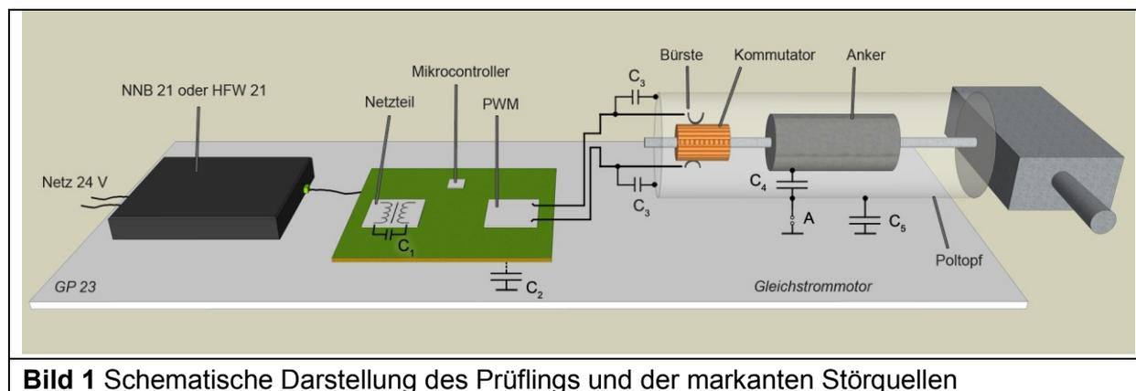
**Bild 1** Schematische Darstellung des Prüflings und der markanten Störquellen
